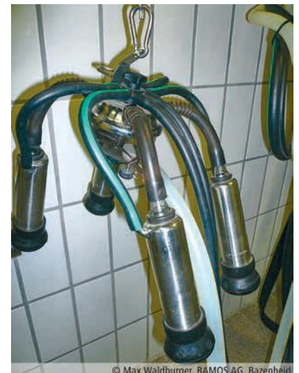
Պարբերաբար սրուգել կթի սարքի մաշվածությունը
