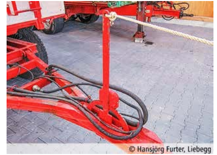
Ֆերմերի արգելակն այսօր ծառայում է միայն որպես կայանման արգելակ:
