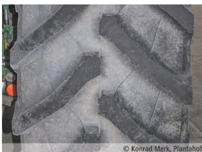
Հողը բռնող խաչաձև սեպերով անվադողերը հարմար են հողագործության համար:
