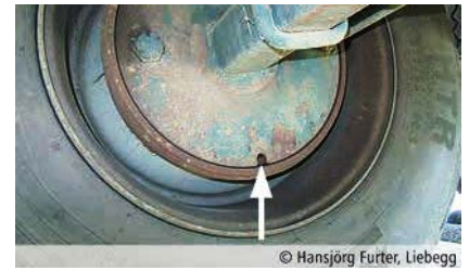
Ս-աձև փոքրիկ անցքը հեշտացնում է արգելակման բարձիկների հաստության կարգավորումը (սլաքը):
