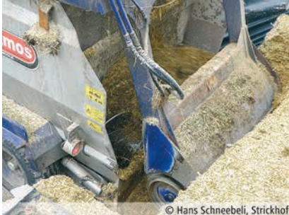
Մենդային խառնուրդը բաղկացած է տարբեր բաղադրիչներից։ Այսպես ֆրեզերային մեքենան հեռացնում է եգիպտացորենի և խոտի սիլոսը և տեղափոխում այն խառնիչ վազոն։
