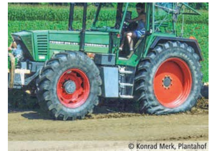
Անվադողերը և գետինը պետք է լարված լինեն՝ ձգողականության ուժի փոխանցումն ապահովելու համար:
