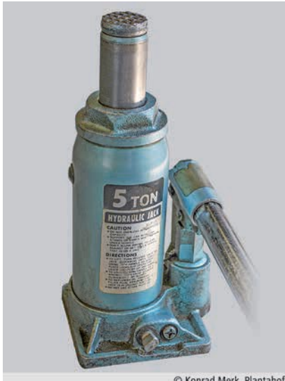
Դոմկրատը կարող է օգտագործել մեծ միաց՝ ճնշումն ավելի մեծ բարձրացնող ուժի վերածելու համար:
