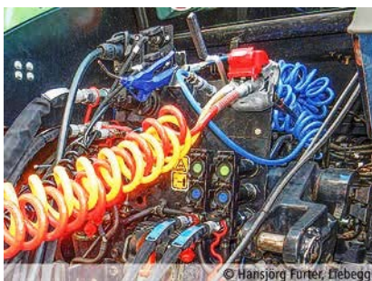
Այսպես օդային արգելակման գծերը միացված են Դուոմատիկ արագ արձակման կցորդիչին: Վերևում ձախից՝ ավերմատ արգելակային համակարգի էլեկտրամատակարարումն է:
