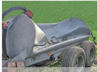
Լցնելիս վակուումային թմբուկը պետք է կարողանա դիմակայել օդի ճնշմանը:
