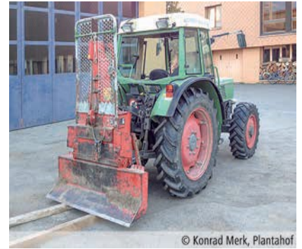
Մալուխային ճախարակի միջոցով կարող են ստեղծվել ավելի մեծ ուժեր:
