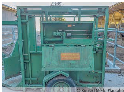
Տասնորդական կշեռքով կարելի է որոշել կենդանիների զանգվածը համեմատության միջոցով
