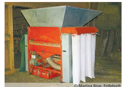
Չոր կերը մաքրող մեքենան ունի փոշին ու հողը չոր կերից հեռացնելու կարողություն
