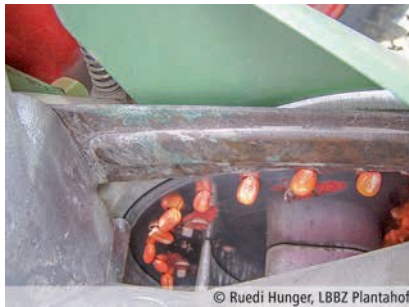
Ներծծող օդային համակարգով սկավառակի մի կողմի վակուումը մյուս կողմից ներծծում է սերմը:
