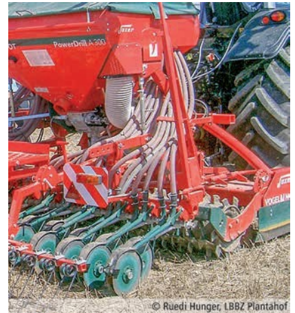
Օդաճնշական սերմնացանը ցանում է սերմը օդի ճնշման միջոցով:
