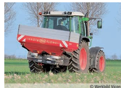
Տարածման օրինաչափությունը կարող է կարգավորվել պարարտանյութի ցրիչը թեքելով:
