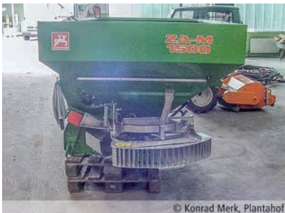
Ժամանակակից եզրային բաշխման սարքերը հնարավորություն են տալիս փարածել գծերի նորմալ փարածությամբ:
