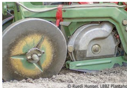
Ճնշման գլանափաթեթը փակում է սերմացուի բացվածքը:
