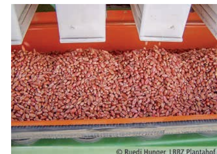
Սերմնացանի կարգավորումները ստուգելու համար որոշակի տարածքի համար (առնվազն մեկ ակր) նախադրեցվող սերմերը հավաքում են տրամաչափման սկուտերի մեջ և կշռում:
