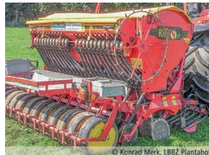
Ճնշման գլանափաթեթները, որոնք հետևում են խոփերին, կրկին սեղմում են հողը՝ սերմերը ակոսներում տեղադրելուց հետո:
