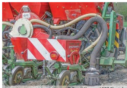
Ճնշման գլանափաթեթը փակում է սերմացուի բացվածքը:
