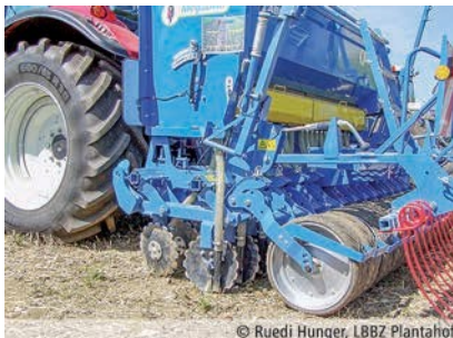
Երեք սկավառակով ուղիղ ցանելու ժամանակ առջևի սկավառակը հողը կտրում է հորիզոնական, իսկ հաջորդ սկավառակները բացում են, որպեսզի սերմը տեղադրվի այնտեղ:
