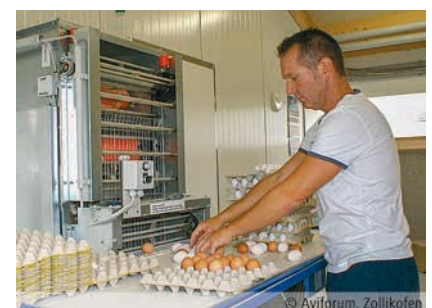
Ձվերը բազմահարկ բներից տեղափոխվում են հավանոցի առջևի մասը հավաքման ժապավենների միջոցով և տեղադրվում հավաքման վայրում վերելակների միջոցով:
