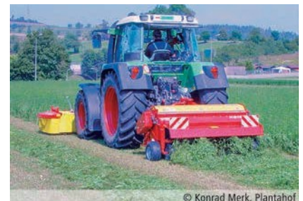
Կոնդիցիոները կարող է ինտեգրվել հնձիչի մեջ կամ ամրացվել տրակտորի հետևի մասում:
