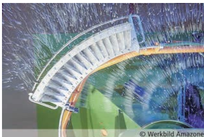
Եզրերով բաշխման համար մաղը պտտվում է պարարտանյութի հոսքի միջով, որը փոխում է հափիկների հեղադիր:
