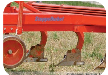
Նախակտրիչով գույթանը բույսերի մնացորդները մակերեսից ներս է հրում հողի մեջ:
