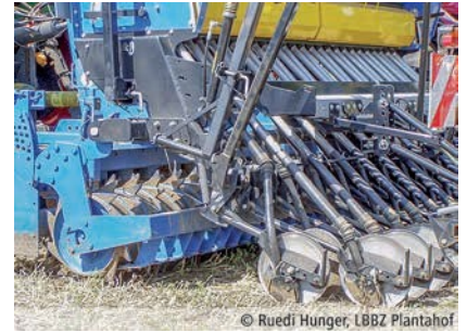
Սկավառակային խոփերն ավելի քիչ են խցանվում, քան հեղուկ քարշակվող խոփերը և շար հարմար են ուղղակի ցանքի համար:
