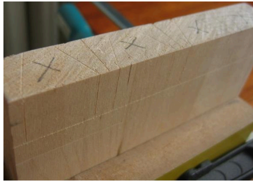
Նկար 164. Ճակատային մասից գծապատկերի տեղափոխումը սղոցամակերևույթի վրա:
