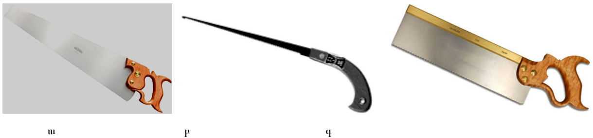
Նկար 48. Ձեռքի սղոցներ՝ ա) լայն ձեռնասղոց, բ) նեղ ձեռնասղոց, գ) կոնակային սղոց
