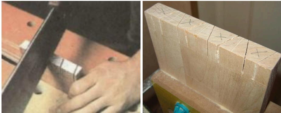
Նկար 166. Փորակների ուղղությունների հաջորդականությամբ սղոցում
