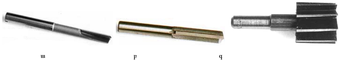
Նկար 124. Հստ կտրող եզրերի քանակի ֆրեզների տեսակները՝ ա) մեկ կտրող եզրով, բ) երկու կտրող եզրերով, գ) մինչև ութ կտրող եզրերով
