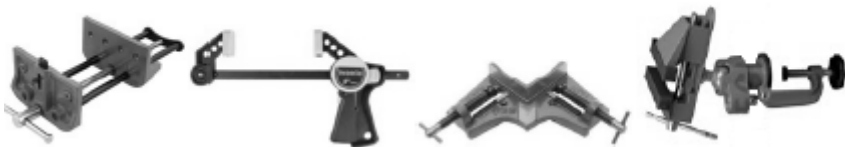
Նկար 75. սեղմակապեր և մամլակ՝ ա, բ) լայնական սեղմակապեր, բ) անկյունային սեղմակապ, գ) մամլակ
