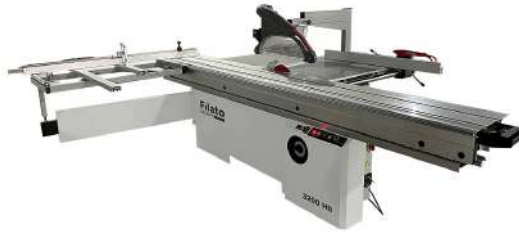
Նկար 126. հորիզոնական ձևաչափային սղոցման հաստոցի ընդհանուր տեսքը
