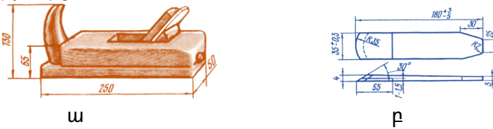
Նկար 93. զոլախ՝ ա) զոլախի ընդհանուր տեսքը, բ) զոլախի դանակը
