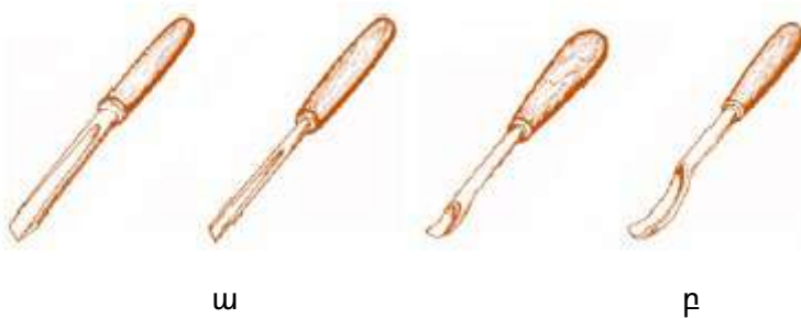
Նկար 118. անկյունային և խորահան մաքրամշակող դուրեր՝ ա) անկյունային, բ) խորահան
