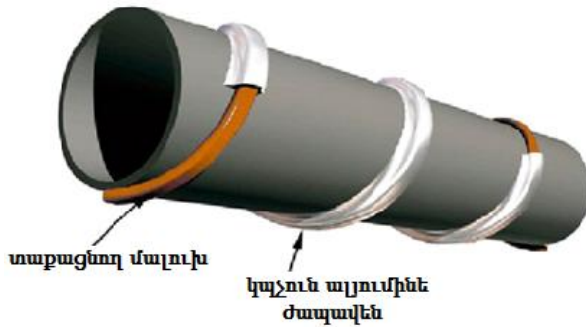
Նկար 107. Տաքացնող մալուխի փաթաթման եղանակով արտաքին տեղադրման սխեման
