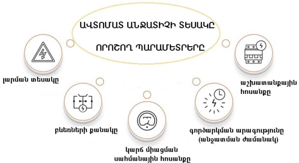
Նկար 112 . Ավտոմատ անջատիչների տեսակները որոշող պարամետրերը
