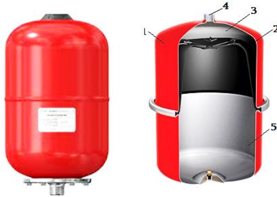
Նկար 98. Ընդարձակման բաքի տեսքն ու կառուցվածքը 1-պողպատե անոթ, 2-դիաֆրագմա, 3-բաքի վերևի մաս, որտեղ մուտք է գործում ջերմակիր հեղուկը, 4-արևային կոլեկտորի փակ շղթային միացման կարճախողովակ, 5- բաքի ներքևի մաս, որը լցված է ազոտով
