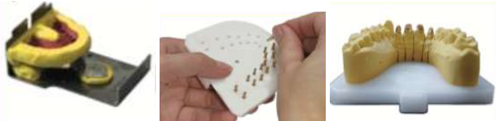
Նկար 190. Կոմբինացված մոդելի ստացումը (Pindex համակարգ)
