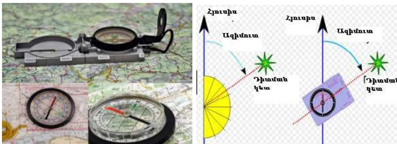
Նկար 2.1.5. Կողմնորոշում տեղանքում քարտեզի և կողմնացույցի միջոցով
