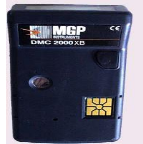
Նկ. 23. MCPD MC 200XB անհատական էլեկտրոնային դոզիմետր
