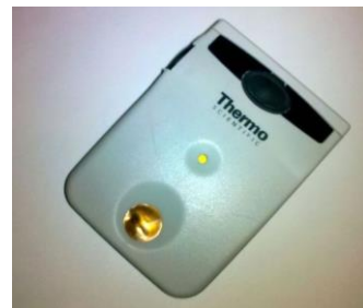
Նկ. 22. Միմենս ՄԿ-2 անհատական էլեկտրոնային դոզիմետր
