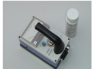
Նկ. 20. ՖՀ-40Ձ իոնացնող ճառագայթման չափիչ սարք
